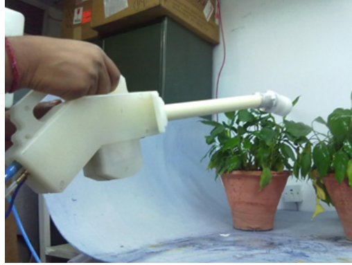
चित्र 2: हवा सहायातित इलैक्ट्रोस्टैटिक कीटनाशक स्प्रेयर
